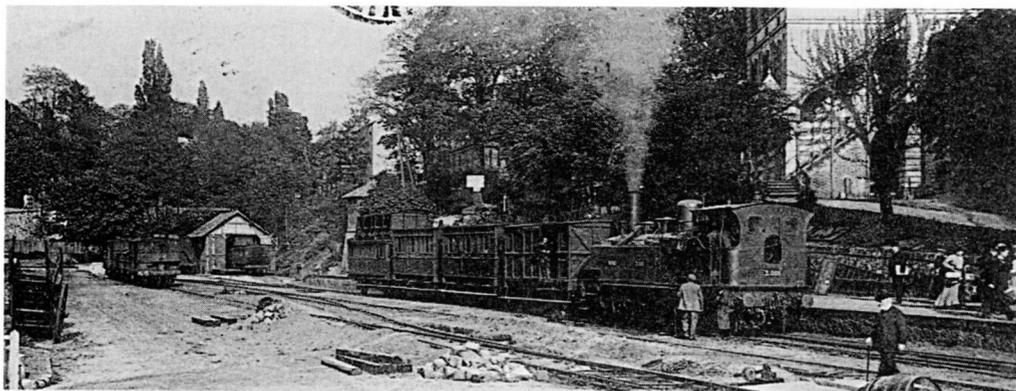
*La 030 T n° 3001 de la série 3001/3010 en gare de Montmorency. Remarquer la remise à voitures au fond. Au premier plan, quelques traverses et pavés attendent leur mise en place sur la voie des débords en cours de réfection.*
